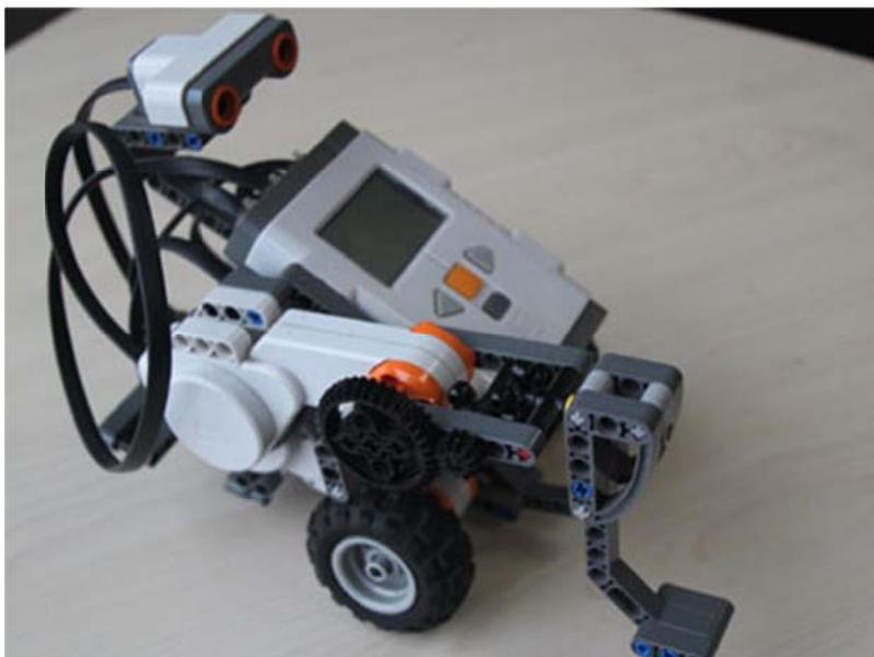
在使用者的家庭环境下，通过随身携带的无线移动脑电采集终端，采集脑波及多种生理信号，经由 3G、无线互联网实时传输至脑波数据处理中心，经计算处理后，提取出脑波中的特征指标，转换成控制指令后再经由无线互联网通路发送至脑感知思维控制机器人，驱动机器人前进、后退、左转、右转等动作，实现脑功能状态的闭环自主调控及亚健康治疗。
